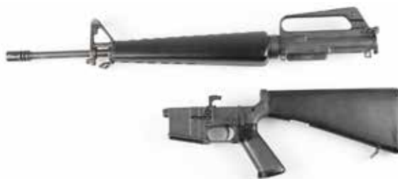
Halvautomatisk rifle delt i upper receiver (øverst) og lower receiver (nederst).
