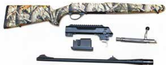
Boltrifle strippet ned til sine hoveddeler: Skjefte, låskasse, sluttstykke, magasin og løp.
