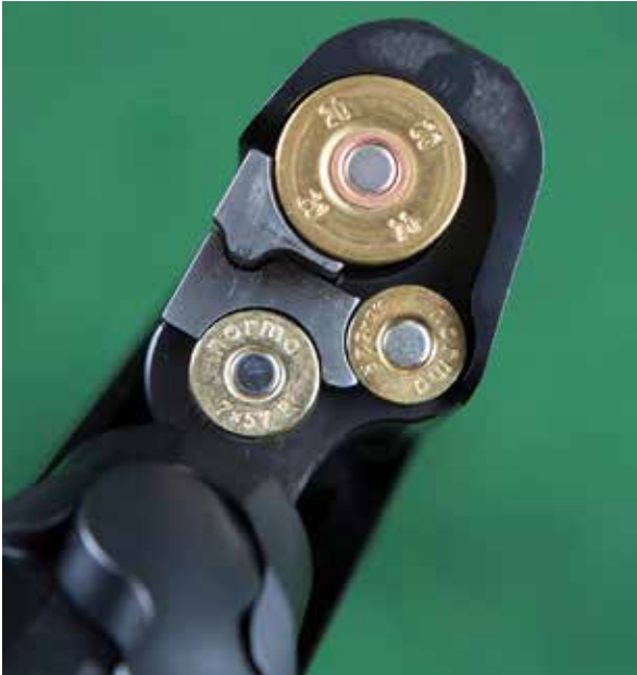
Dette kombivåpenet består av et hagleløy og to rifleløy i ulike kalibre.
