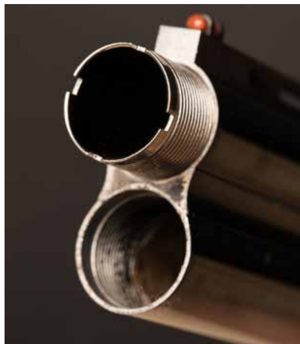
Trangboringer kommer i ulike varianter, og kan på mange våpen byttes ved at man skruer inn choker foran i løpet.
