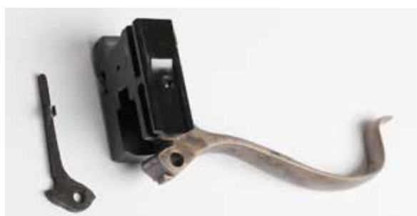
Låseblokken beveger seg vertikalt i forhold til løpets lengde. Når blokka trekkes ned, kan patron lades i kammeret.
