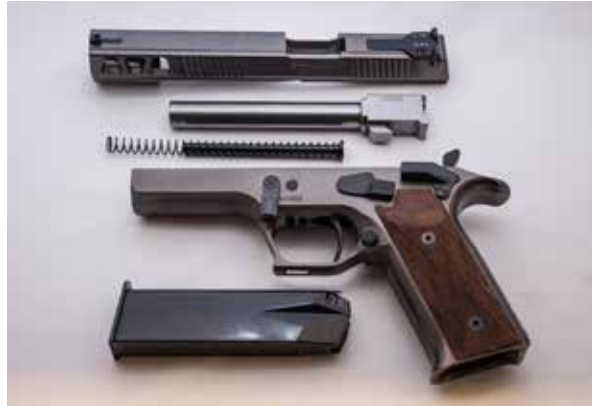
Pistol strippet for pussing. Delene er glidestykke, pipe, fjær og styrepinne, rammestykke med grep og avtrekk og magasin.
