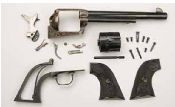
Hoveddelene i en revolver: Rammestykke med løp, hane, tønne, grepstykke og grep. Øvrige deler utgjør mekanismen i denne single action-revolveren.
